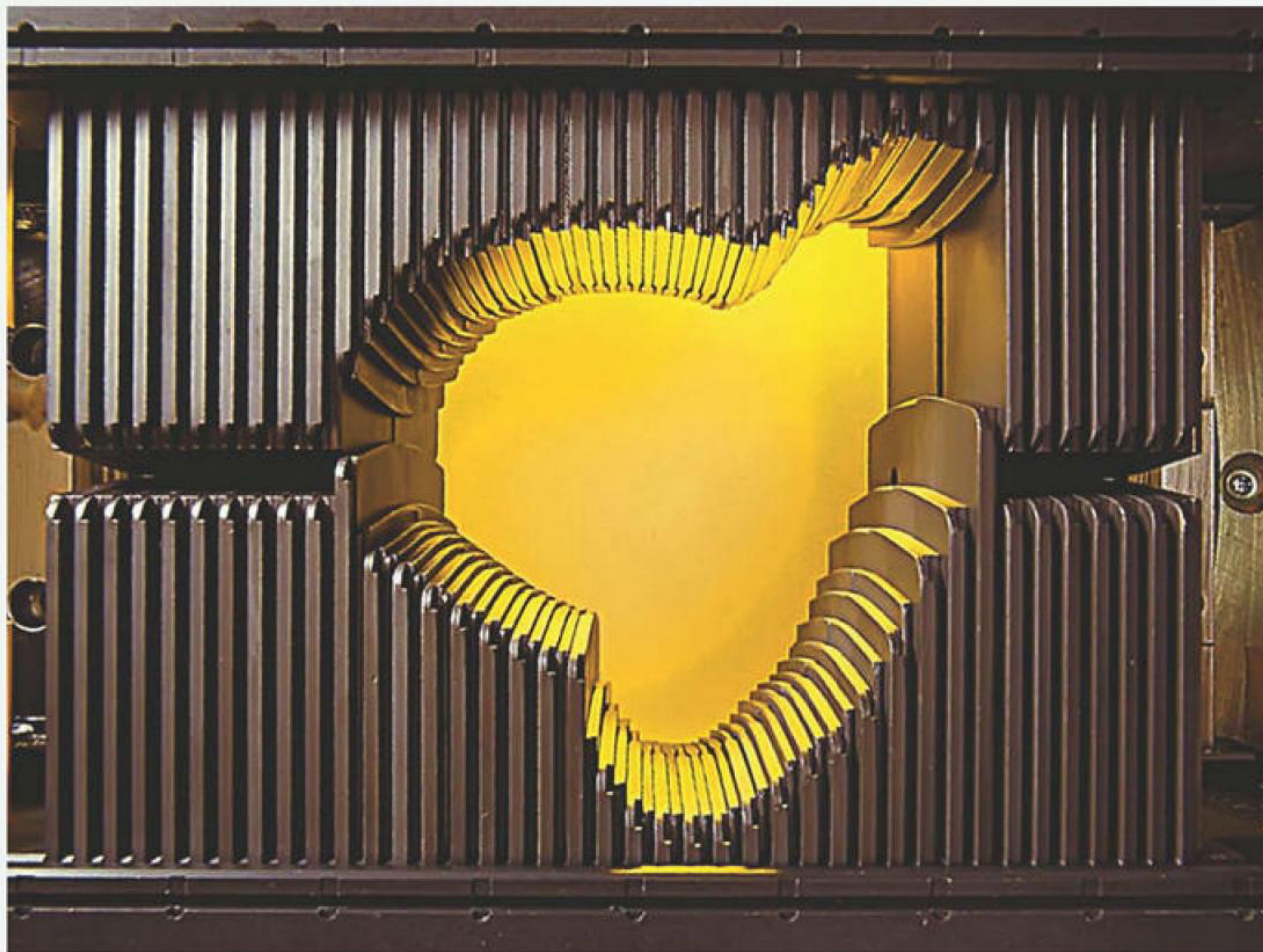
▲ Отверстие коллиматора задает поперечную форму пучка с точностью до миллиметра
